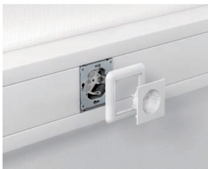
GK/GS/GA szerelvénydoboz szerelése A 76,5 mm tényleges csatornanyílás-szélesség biztosítja azt, hogy még a nagy külső sugarú szerelvénykeretek sem hagynak látható nyílásokat a csatornafedél és a keretek között.
