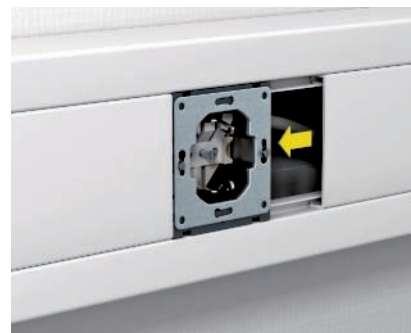
Vízszintes eltolás A szabványnak megfelelően biztosítani kell, hogy a szerelvénydobozok ne legyenek eltolhatóak. Ez a doboz felső részének felszerelésével történik, mivel ez szorosan záródik a szerelvénydobozra.
