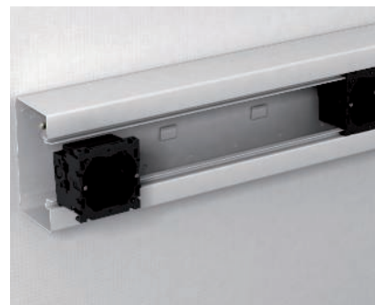
GK/GS/GA szerelvénydoboz szerelése A 71GD... sorozatú szerelvénydobozokat bele kell pattintani a fedélprofilba. A dobozok hosszanti irányban eltolhatók a csatornában.
