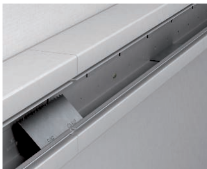
GS/GA összekötő csatlakozó szerelése Helyezze bele az összekötőt a szerelvénybeépítő csatorna felső részébe és nyomja bele a csatornába. Így az összekötő automatikusan rögzítődik, és egyúttal biztosítja a csatorna két alsó részének potenciálkiegyenlítését.
